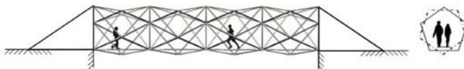
Рисунок 12. Пешеходный мост «тенсегрители», имеющий конструкцию «полый канат» Источник: http://tensegrity.wikispaces.com/Bridges
