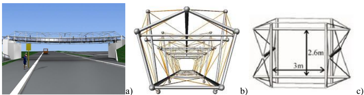
Рисунок 11. Проект пешеходного моста Тор Вергата в Риме, Италия: а) общий вид моста; б и в) – модули «тенсегрители» конструкции моста Источник: http://tensegrity.wikispaces.com/Bridges
