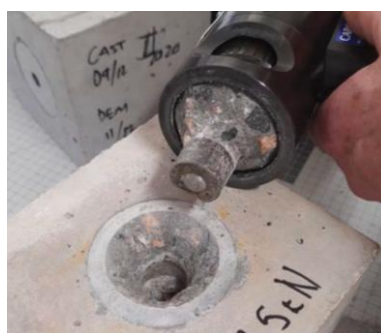
Рисунок 2. Правильная коническая форма вырванного фрагмента бетона при испытании по схеме LOK-test (источник: [6])
