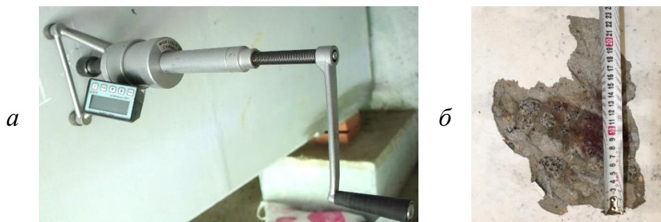
Рисунок 3. (а) нагружающее устройство ПОС-50МГ4; (б) свободная форма вырываемого фрагмента (фото автора)
