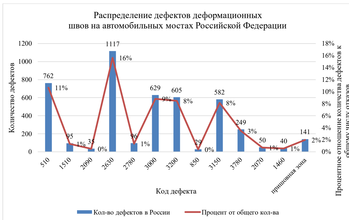
Рисунок 4. Диаграмма распределения дефектов деформационных швов на федеральных автомобильных дорогах Российской Федерации (разработано авторами)
