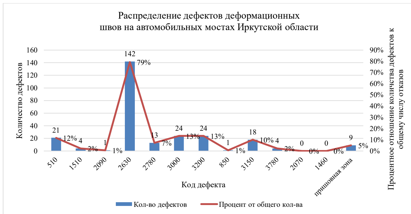
Рисунок 6. Диаграмма распределения дефектов деформационных швов на мостах федеральных автомобильных дорог Иркутской области (разработано авторами)
