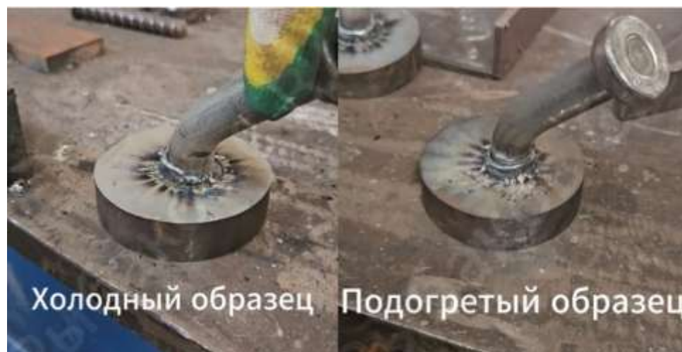
Рисунок 9. Образцы после испытания на загиб (разработано авторами)
