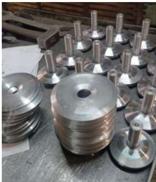
Рисунок 7. Образцы высокопрочных болтов и шайб (разработано авторами)
