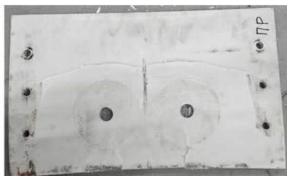
Рисунок 27. Композитные листы после испытаний (разработано авторами)
