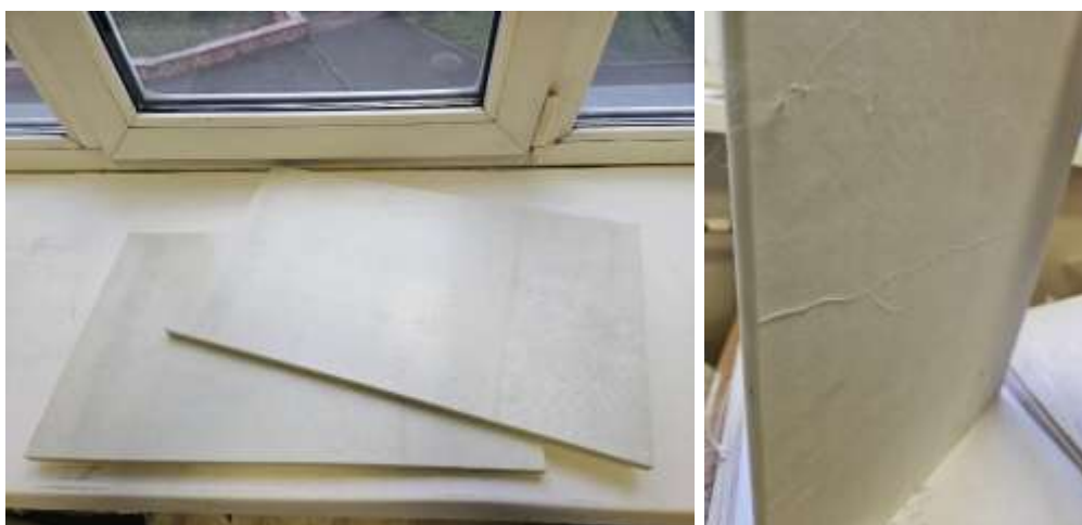
Рисунок 6. Композитные листы и дефект на них (разработано авторами)
