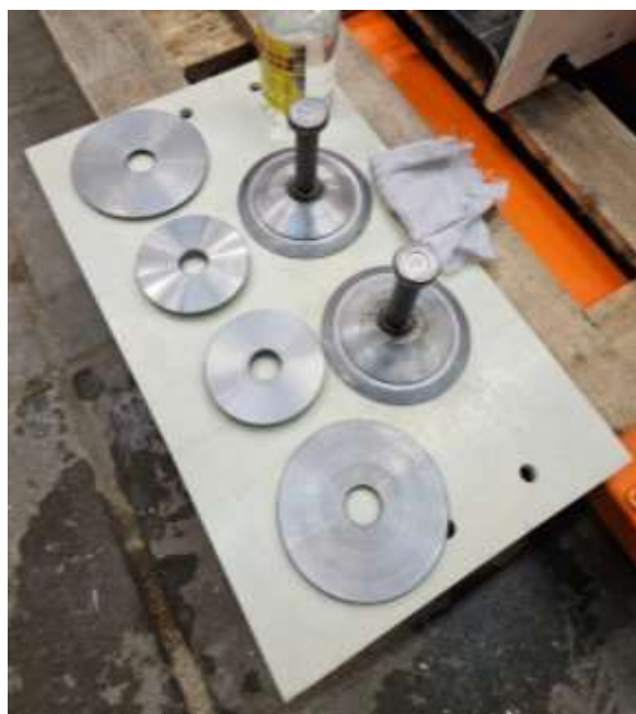
Рисунок 11. Подготовка поверхностей композита и упоров (разработано авторами)
