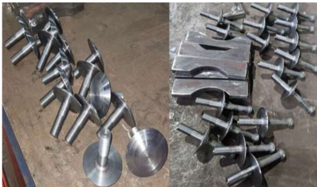
Рисунок 10. Высокопрочные болты: до и после КСО (разработано авторами)
