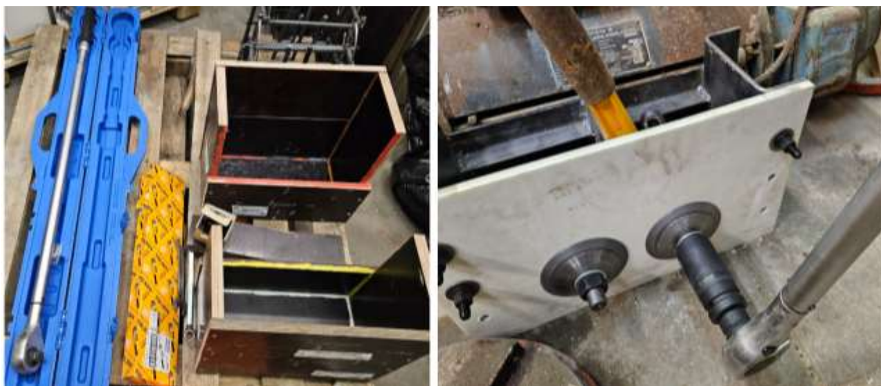
Рисунок 12. Процесс затяжки высокопрочных болтов (разработано авторами)
