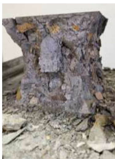
Рисунок 4. Форма разрушения образцов (разработано авторами)
