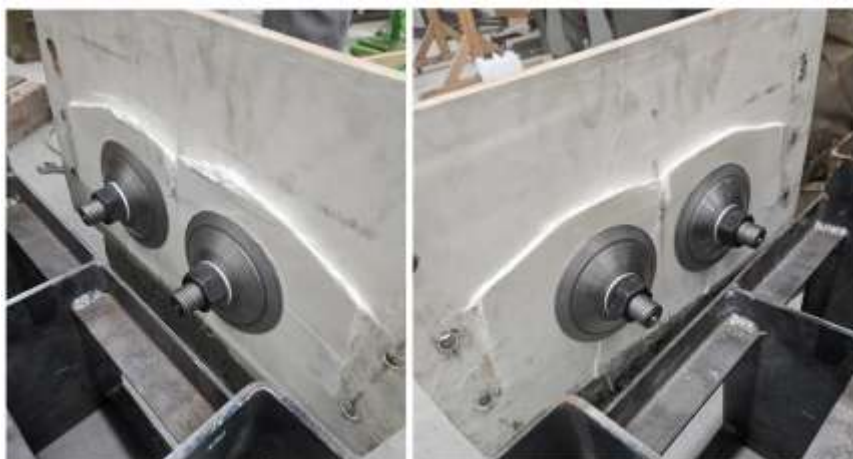
Рисунок 26. Левая и правая части образца после испытаний (разработано авторами)
