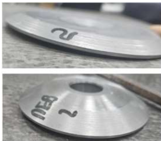
Рисунок 29. Деформации внутренней и внешней шайбы (разработано авторами)
