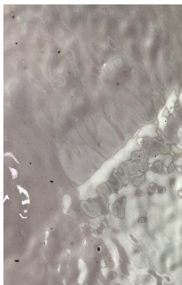
Рисунок 10. Образование каверн из-за пузырькообразования в образце из полимочевины (фото автора)
