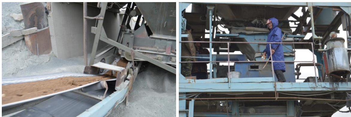
Рисунок 1. Загрузка компонентов и получение смеси на основе дисперсного вязкого битума (рисунок авторов)
